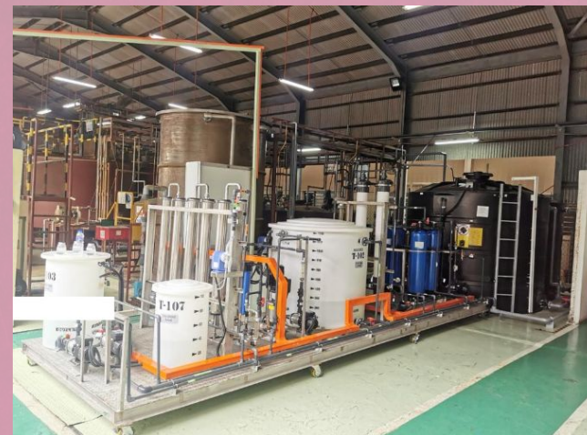
Sistem berskala pilot berasaskan membran yang dibangunkan di bawah projek ini yang ditempatkan di KYB-UMW Malaysia
